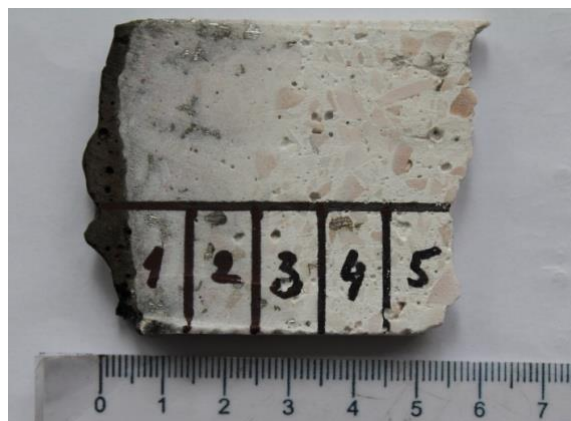
Obr. 6 úlomok KOFOND SP 25 CM pre fázovú analýzu iasť 1) zhutnená iasť ovplyvnená oceľou a troskou, 2) neovplyvnená iasť
