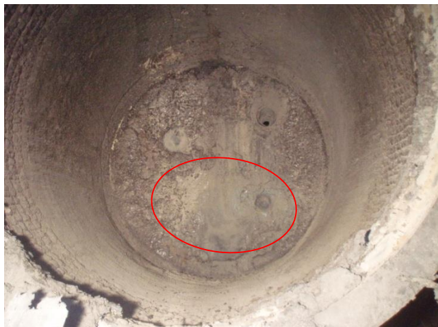
Obr. 1 Miesto dopadu na dne liacej panvy pred začiatkom istením
