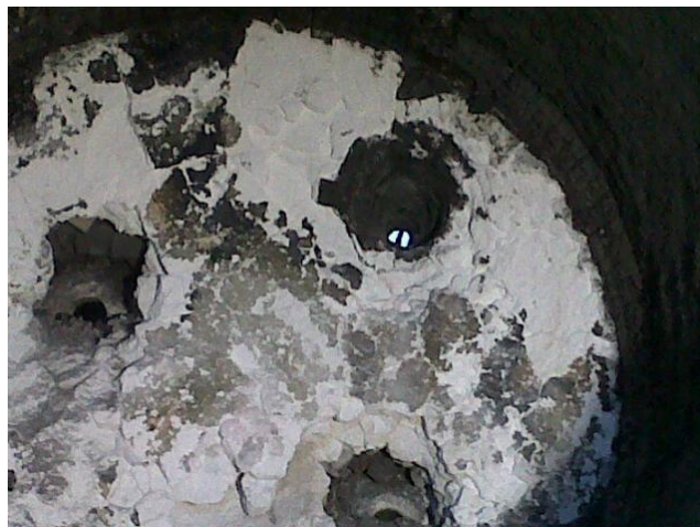
Obr. 2 Miesto dopadu na dne liacej panvy po začiatku istením
