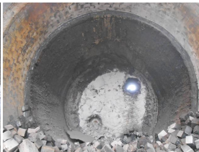
Obr. 4 Ľavo: Miesto dopadu na dne liacej panvy po začiatku istením KOFOND SP 25 CM
