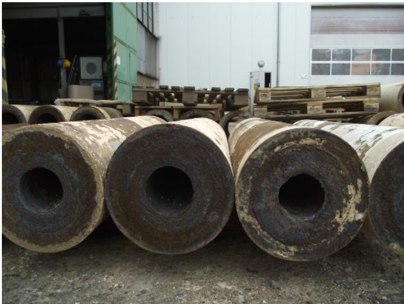
Obr. 2 Surové silnostinné odstředivě lité odlitky
