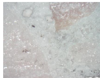
Obr. 7 Úlomok KOFOND SP 25 CM pre fázovú analýzu iasť 1) zhutnená iasť ovplyvnená oceľou a troskou, 4) neovplyvnená iasť
