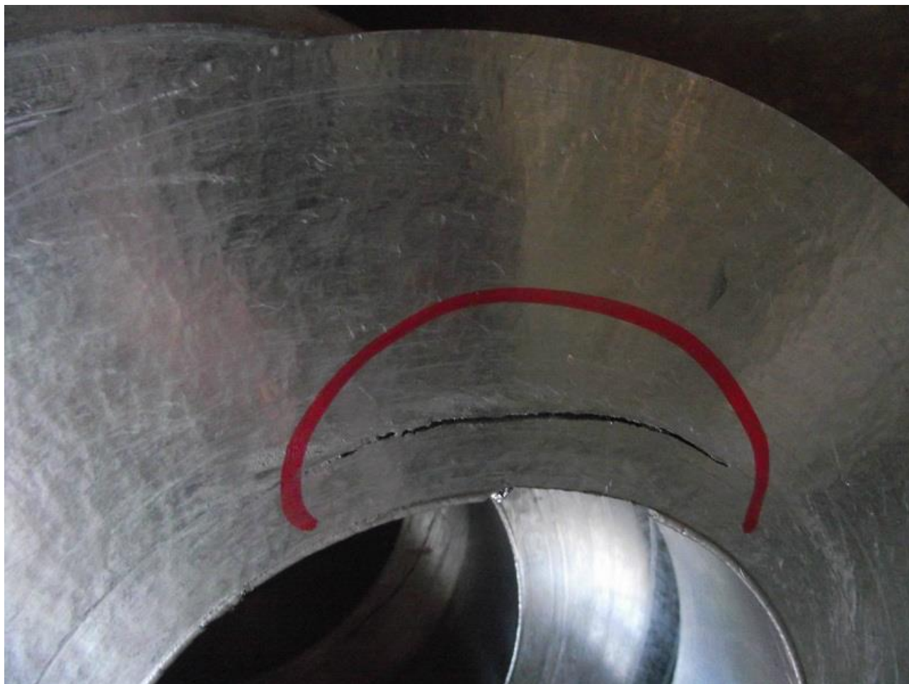
Obr.4 Vnitřní trhlinka v kolmém řezu na osu odlitku trubky
