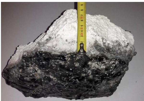
Obr. 5 úlomok KOFOND SP 25 CM po 98 liatiach
