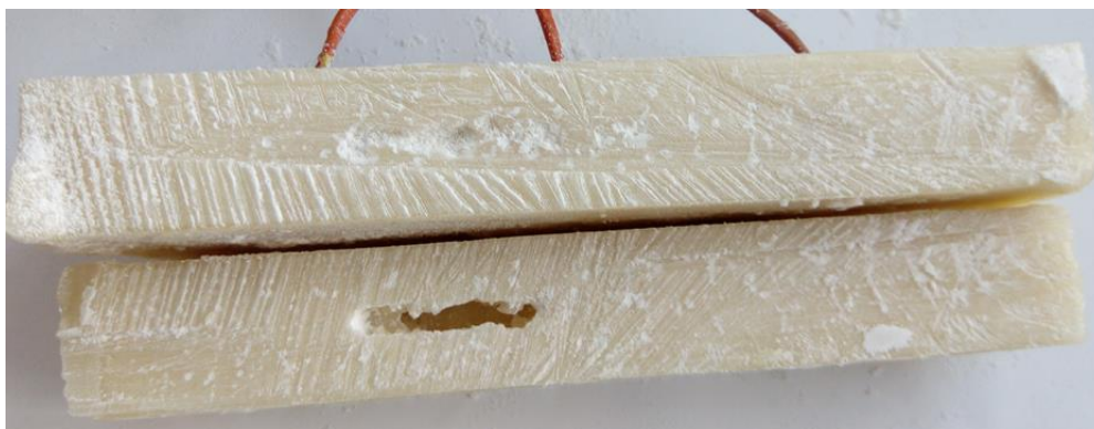
Obr. 9 Stiahnutiny a dutiny vo vzorkách
