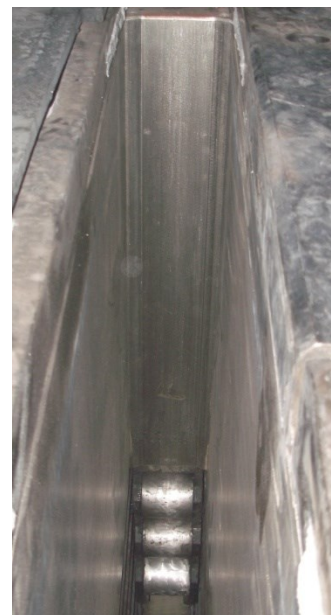
Obr. 3 Pohled na pracovní povrch tvarově upravené desky krystalizátoru (nahore) a pohled na zabudovanou desku v krystalizátoru (vpravo)
