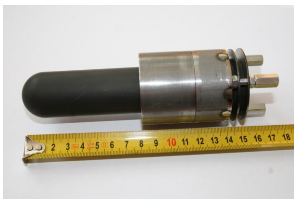
Obr. 4 Pohled na ochrannou trubici z SiC a její mechanické upevnění
