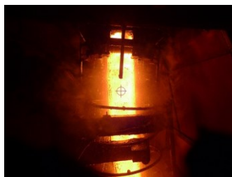
Obr. 6 Pohled přes bezkontaktní teploměr
