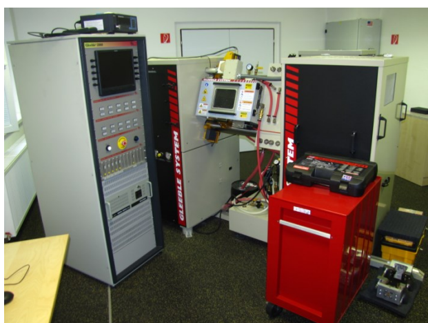
Obr. 2 Priebeh tlakovej skúšky vo fyzikálnom simulátore Gleeble 3800
