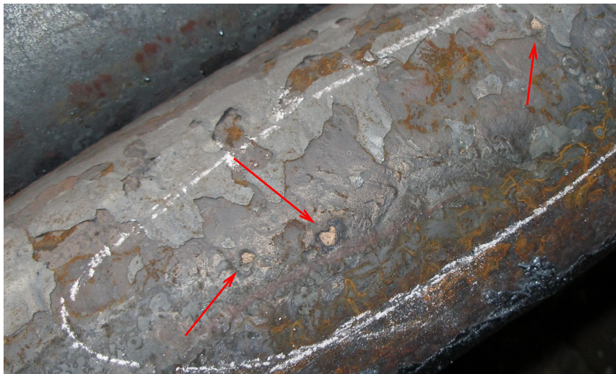
Obr. 2 Výskyt nekovových fází na povrchu sochoru
