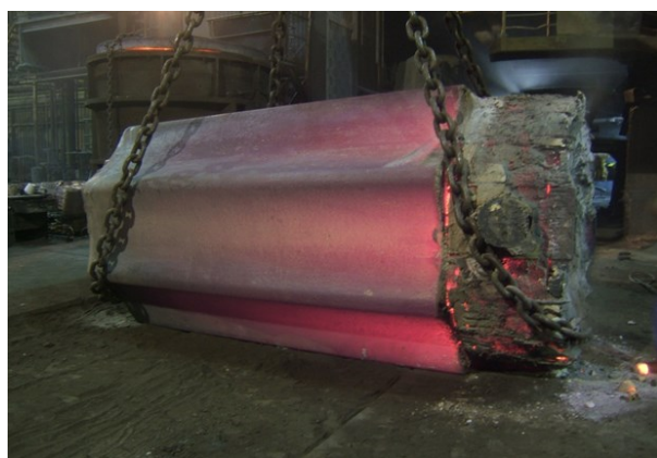
Obr. 1 Experimentální ingot 8K91SF po vystripování z kokily a jeho snímek z termokamery
