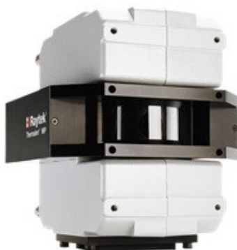
Obr. 7 Řádkový teplotní skener MP 150
