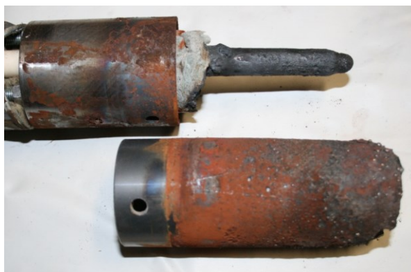
Obr. 3 Ochranné trubice po měření
