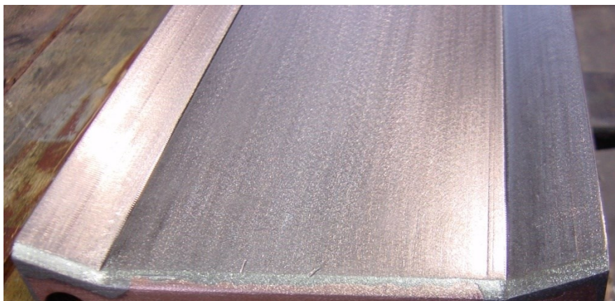
Obr. 3 Pohled na pracovní povrch tvarově upravené desky krystalizátoru (nahore) a pohled na zabudovanou desku v krystalizátoru (vpravo)
