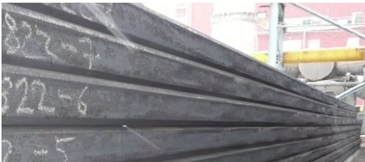
Obr. 4 Vzhled odlitých bram s využitím optimalizovaných tvarově upravených úzkých desek krystalizátoru
