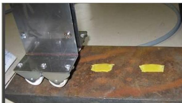
Obr. 2 Pohled na jednoduché mechanické zařízení pro snímání zkušební povrchu (vlevo) a laboratorní model s posunem laserového snímače (vpravo)
