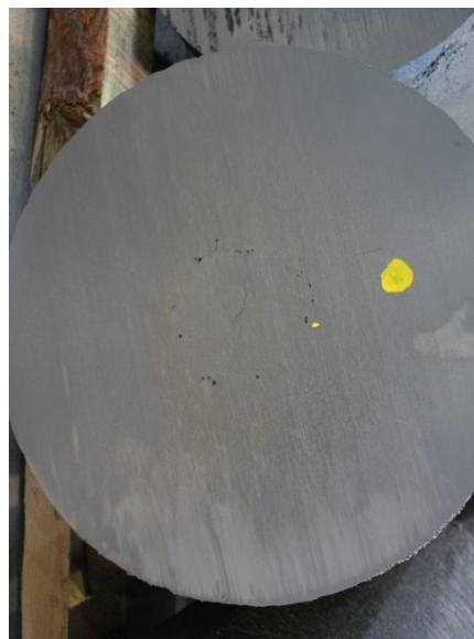
Obr. 27 Staženina v rozřezaném ingotu t.č. 20612
