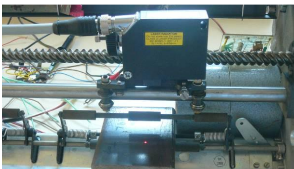
Obr. 2 Pohled na jednoduché mechanické zařízení pro snímání zkušební povrchu (vlevo) a laboratorní model s posunem laserového snímače (vpravo)
