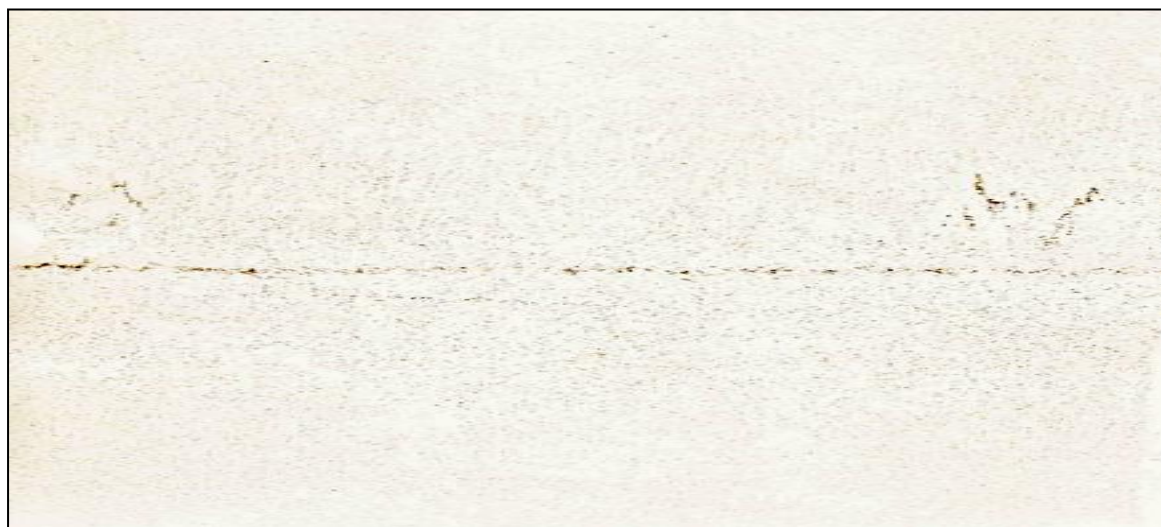
Obr. 3 Příčné vnitřní trhliny na Baumannovém otisku; ukázka z katalogu vad Fig. 3 Transverse internal cracks on sulphur print; example from the catalogue of defects
