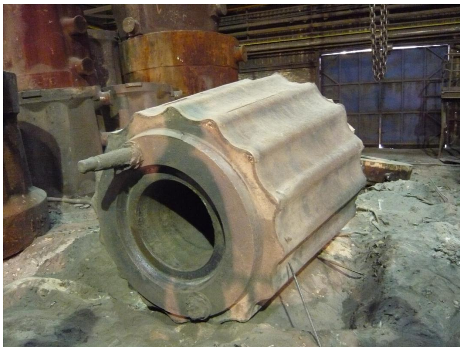
Obr. 3 Dutý ingot o hmotnosti 57 tun odlitý na elektroocelárně VHM a.s.
