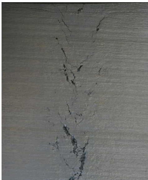
Obr. 26 Staženina v rozřezaném ingotu t.č. 20589
