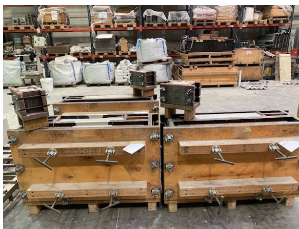
Obr. 2 Ukázka technologie výroby prefabrikovaných tvarovek
