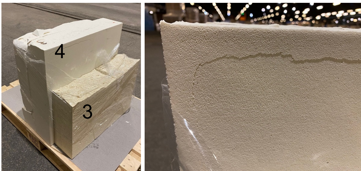
Obr. 6 Vzhled tvarovek po výpalu (vlevo); detail trhliny podél hrany tvarovky rec. 4 (vpravo)
