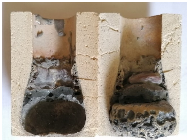
Obr. 2 Působení manganové oceli na materiál F36
