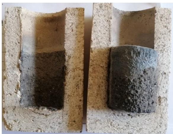
Obr. 3 Působení běžné konstrukční oceli na materiál MK82
