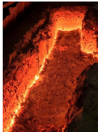
Obr. 7 Stav medzipanve po ukončení testu, po 16. tavbe
