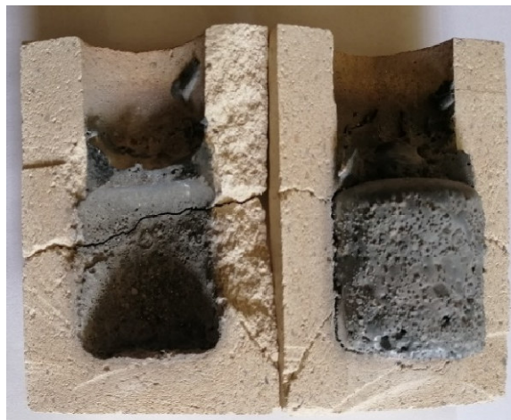
Obr. 1 Působení běžné konstrukční oceli na materiál F36
