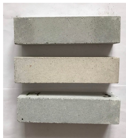
Obr. 1 Zkouška rozlití kužele dle ASTM C230 (vlevo); zkušební trámečky 40x40x160 mm (vpravo)
