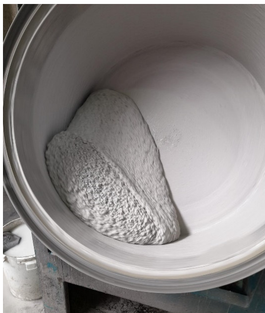
Obr. 3 Po 2 minutách mísení směs 1 začala tvrdnout již v míchačce (vlevo); směs 2 při míchání (vpravo)
