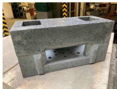
Obr. 5 Sestava spalovací komory, otvory pro přívod sekundárního vzduchu ve spodní části komory
