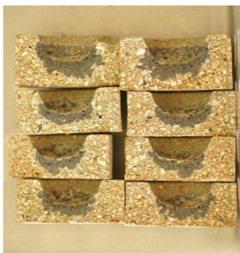
Obr. 5 Štúdia korózie téglikov upchávkovvej hmoty pri teplote 1380°C
