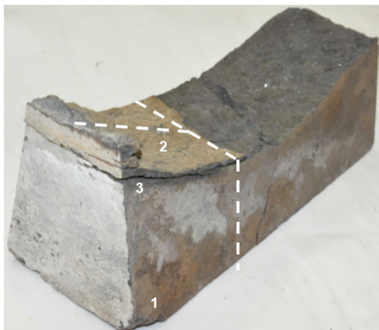
Obr. 2 Vzhľad produktu po prevádzke značky SFG. Biela bodkovaná čiara označuje smer rezu pri príprave skúšobných vzoriek. 1 - studený koniec staviva, 2 - tvorba odlupujúcej sa vrstvy na pracovnej strane, 3 - prasklina
