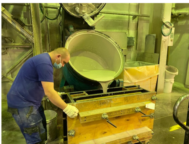
Obr. 2 Ukázka technologie výroby prefabrikovaných tvarovek
