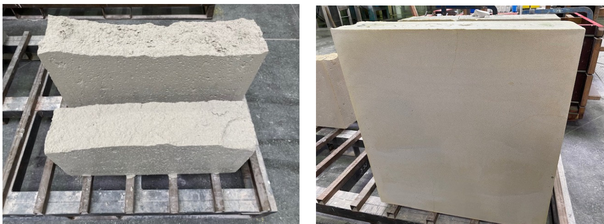
Obr. 5 Poškození tvarovky během odformování u směsi 3 (vlevo); prasklina na u tvarovky ze směsi 4 (vpravo)
