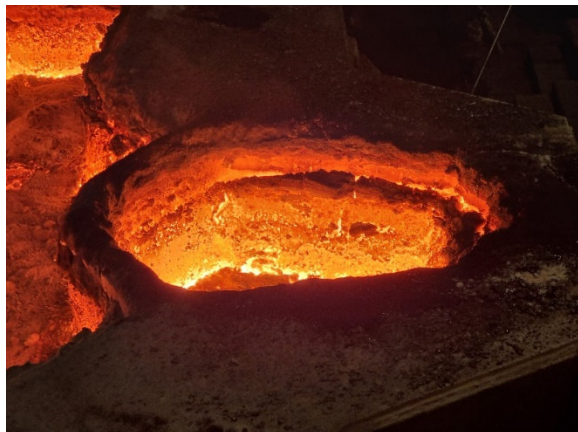
Obr. 6 Stav miesta vtoku po ukončení testu, po 16. tavbe
