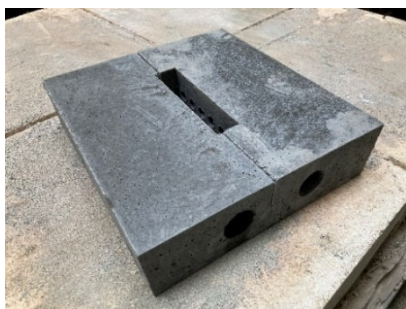
Obr. 4 Sada tvarovek dna násypky s otvory pro přívod sekundárního vzduchu do trysky
