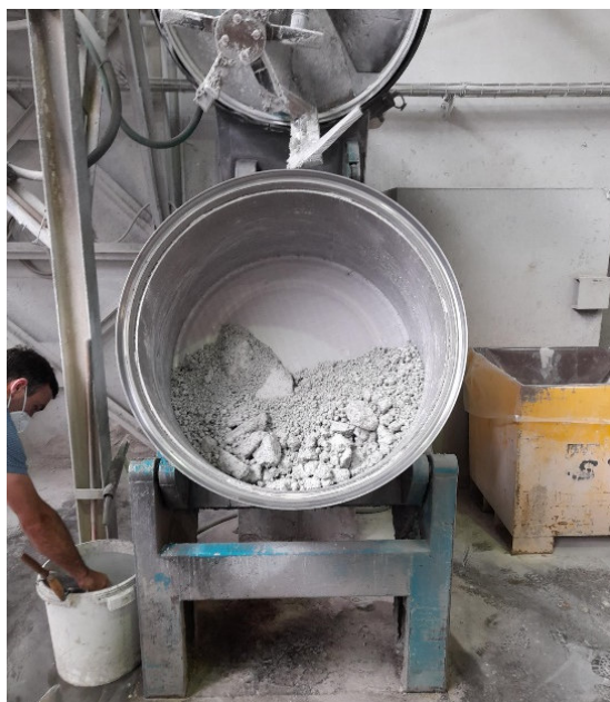
Obr. 3 Po 2 minutách mísení směs 1 začala tvrdnout již v míchačce (vlevo); směs 2 při míchání (vpravo)
