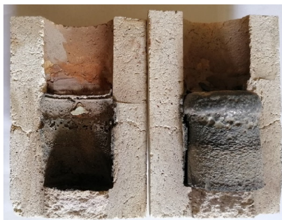
Obr. 4 Působení manganové oceli na materiál MK82
