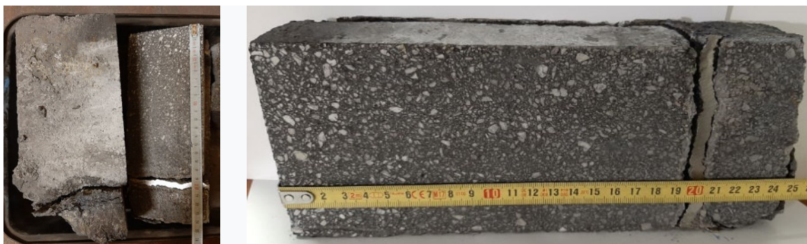
Obr. 2 Stavivo ALKO 85 AMC-K odobraté po ukončení kampane z dna liacej panvy
