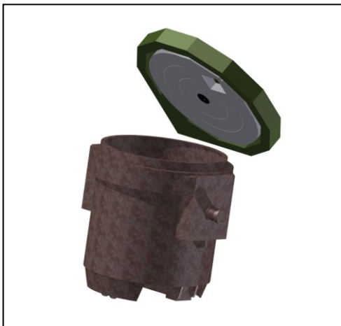
Obr. 1 – Svislé ohřevové víko licích pánví, varianta A
