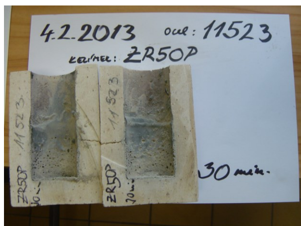
Obr. 3 Zkouška s ocelí 11523, keramika ZR50p
