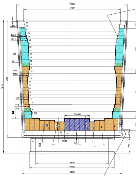
Obr. 1 Skladba vyzdívky licí pánve
