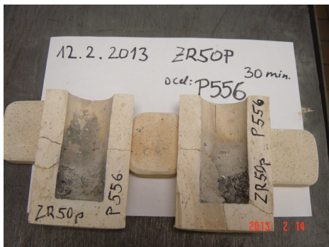
Obr. 5 Zkouška s ocelí P556, keramika ZR50p
