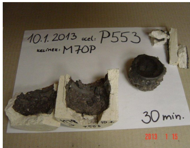
Obr. 6 Zkouška s ocelí P553, keramika M70p
