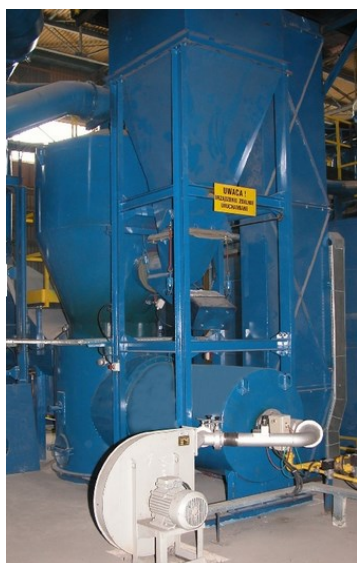
Obr. 2 Fluidní suška SF-12 ve firmě Hüttenes Albertus Lublin (Polsko)
