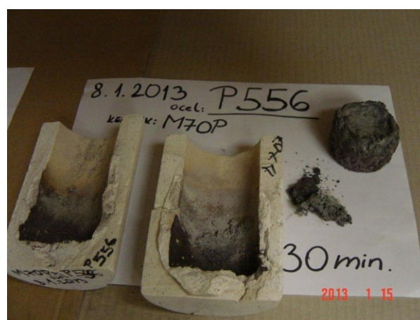
Obr. 4 Zkouška s ocelí P556, keramika M70p
