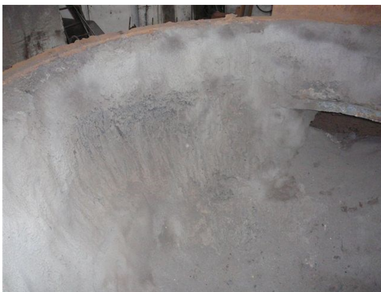
Obr. 2 Pohled na zdivo EOP po torkretaci a vysušení tvořené hmotou UŽH
