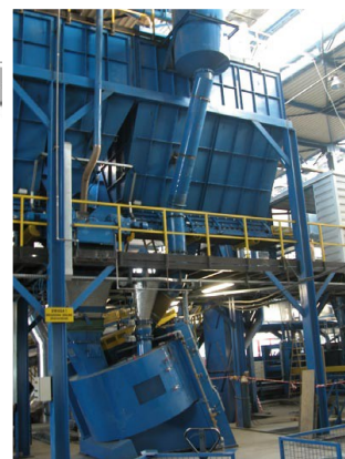
Obr. 8 Systém přípravy formovací směsi ve vířivém mísiči
