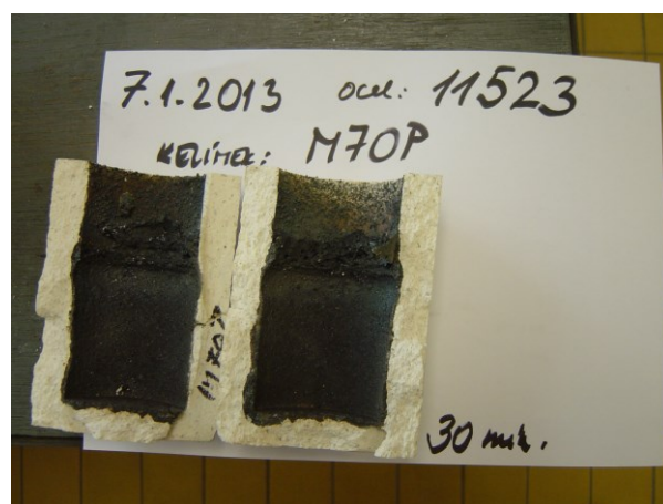
Obr. 2 Zkouška s ocelí 11523, keramika M70p
