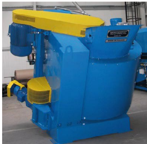
Obr. 4 Vířivý mísič s otočnou mísou a se skloněnou osou otáčení MTP a MTS.
