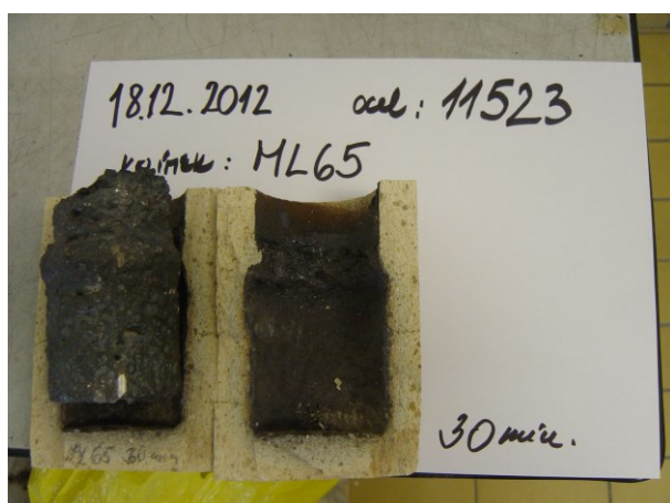
Obr. 1 Zkouška s ocelí 11523, keramika ML65
