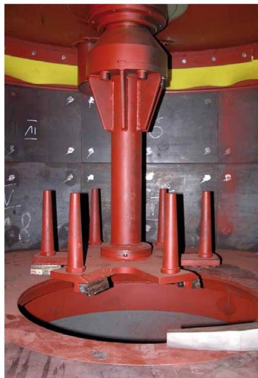
Obr. 7 Rychloběžná turbína v mísiči MTS-500
