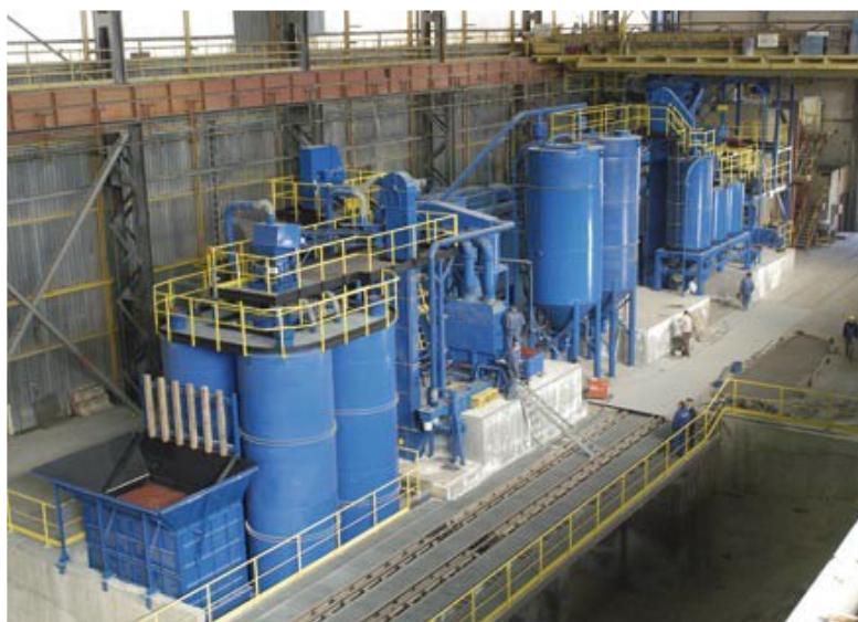
Obr. 3 Zařízení na sušení křemenného písku GSP-12 ve firmě Hüttenes Albertus Lublin (Polsko)
