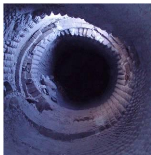
Obr. 2 Opotrebenie PM po 673 naliatiach.
