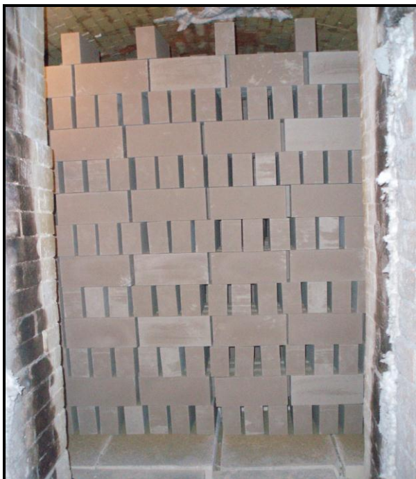
Obr. 2 Komorová pec zavezená Izolanem C
