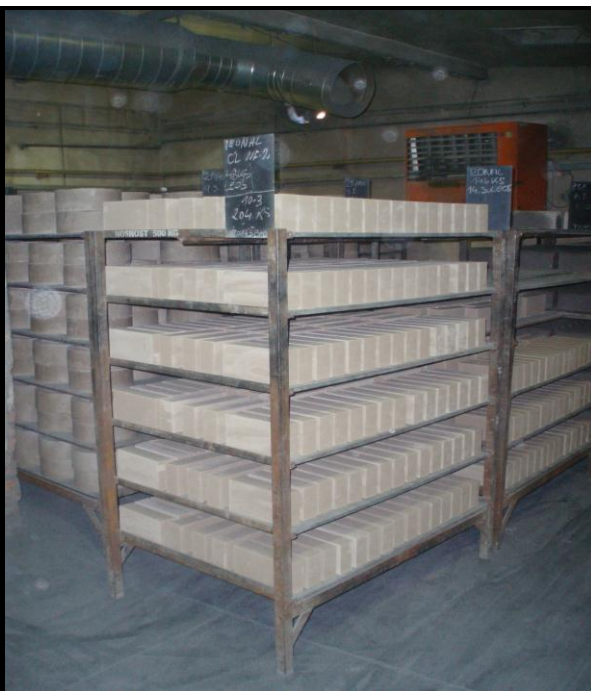
Obr. 3 Sušící regál zaplněný tvarovkami NF2
