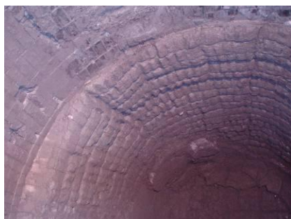
Obr. 1 Opotrebenie troskovej čiary na 10. a 2. hodina.
