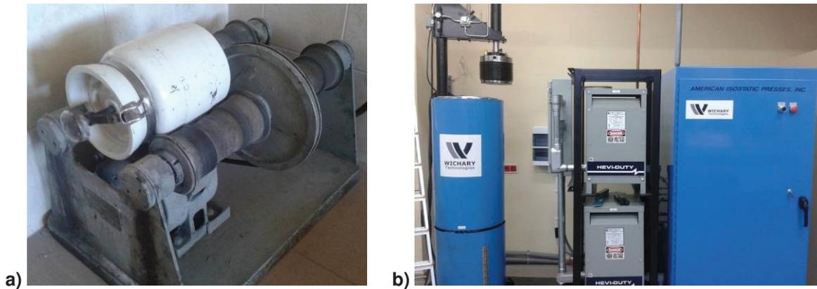
**Figure 2** a) Mixer, b) hot isostatic press HIP AIP8-30H-PED
