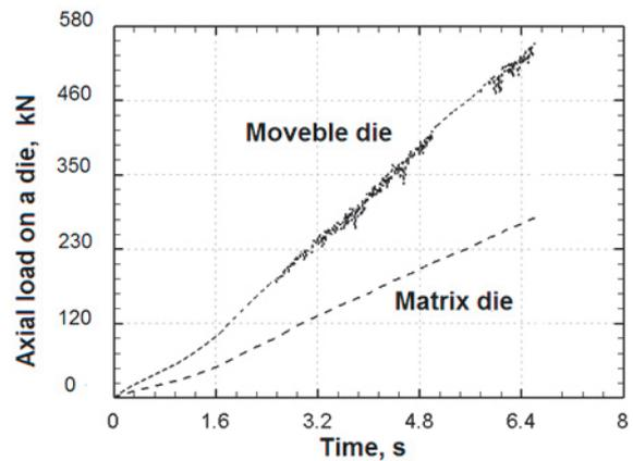
b) stretch forming using matrix die type B
